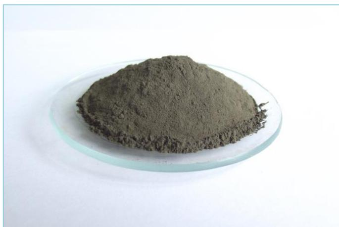
Рисунок 5. Фотографическое изображение пробы галенитсодержащего концентрата №1.
